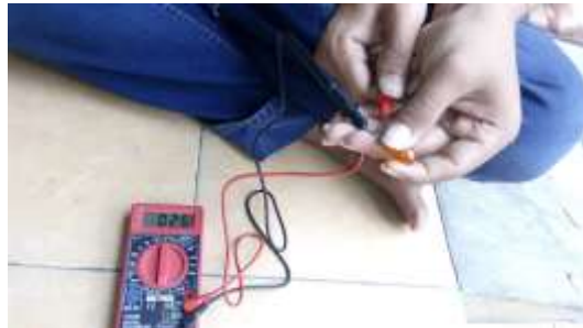
Gambar 4. 3 pengecekan tahanan bohlam lampu tanda belok
