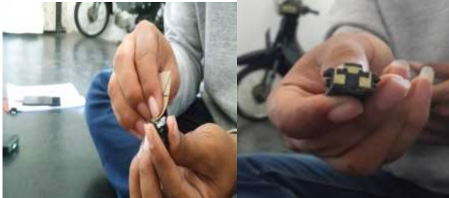
Gambar 4. 13 proses membersihkan menggunakan kertas amplas (kiri), kuningan saklar dimmer setelah dibersihkan(kanan)
