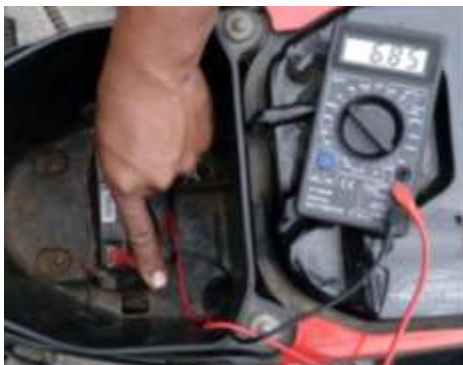
Gambar 4. 6 Baterai kekurangan tegangan
