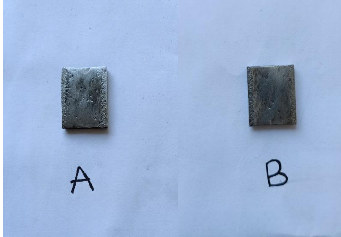
Gambar 3.15 spesimen baja karbon A dan B , sebelum perendaman cairan limbah.
