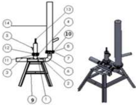
Gambar 1 bagian-bagian pompa hidram
