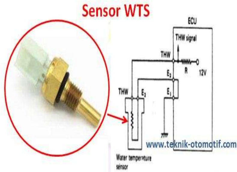
Gambar 2.11. sirkuit kelistrikan sensor ECT
