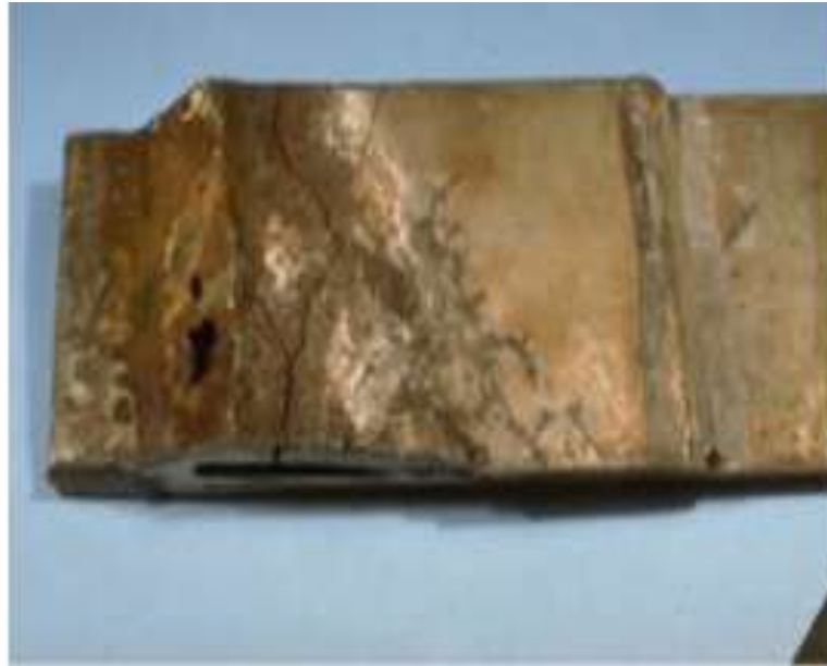
Gambar 2.7 Korosi SCC pada sebuah logam (Deky; 2014)
