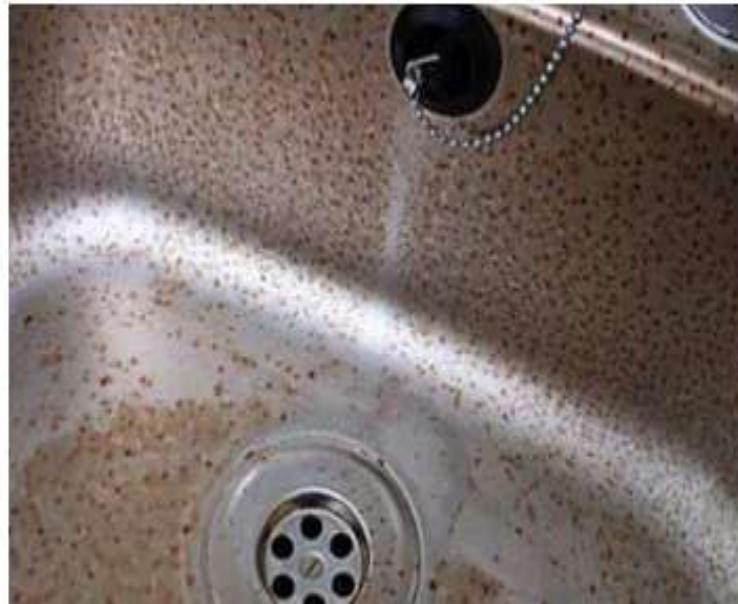
Gambar 2.6 Korosi sumuran pada westafle (Deky; 2014)
