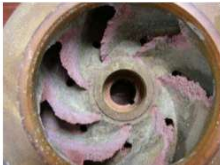
Gambar 2.9 Sebuah blade akibat korosi erosi (Deky; 2014)
