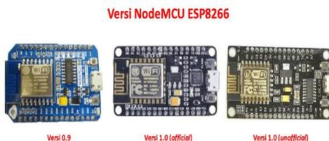
Gambar 1. NodeMCU ESP8266
