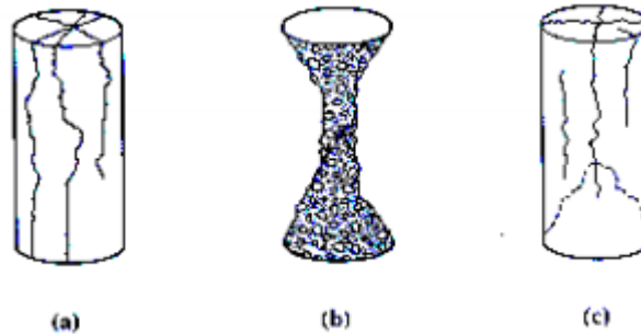
Gambar 11 Benda uji silinder untuk uji kuat tekan
