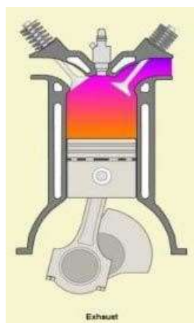
Gambar 2.9 Langkah buang motor bensin 4 TAK
