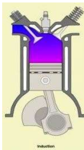
Gambar 2.6 Langkah hisap motor bensin 4 TAK
